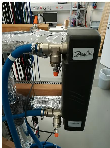
Wärmetauscher am Kühlkreislauf-Versuchsaufbau
